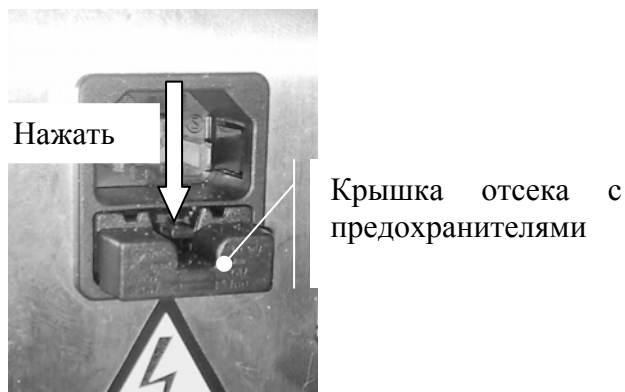
Рис. 5 Отсек с предохранителями
