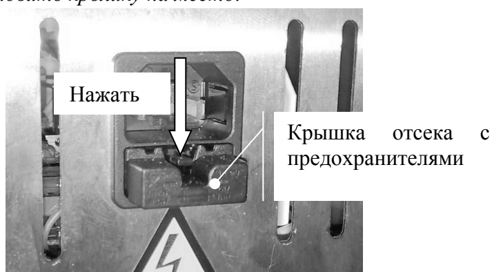
Рис. 7 Отсек с предохранителями
